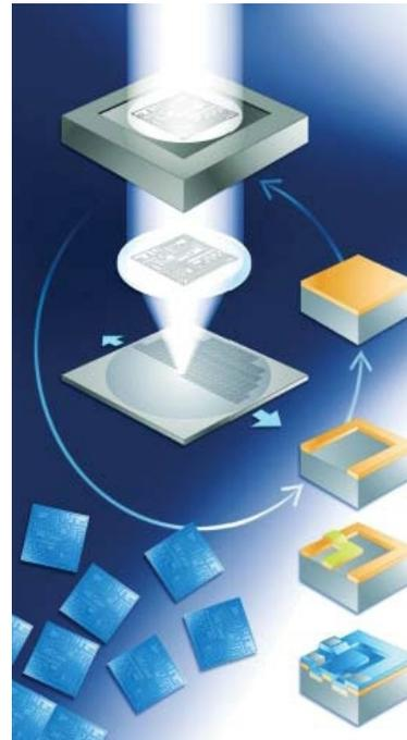
Nella *fotolitografia*, la superficie levigata di un wafer di silicio, è coperta da un rivestimento protettivo fotosensibile sul quale viene proiettata l'immagine di un circuito, opportunamente rimpicciolita grazie ad un sistema lenticolare. Lo sviluppo di questo rivestimento protettivo evidenzia le zone esposte del wafer, che acquisiscono in seguito le proprietà elettriche richieste mediante processi quali l'incisione, l'impianto ionico e la deposizione.
