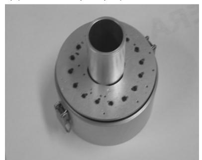
Fig. 25 - Superficie di raccolta di un separatore per la frazione PM2.5
